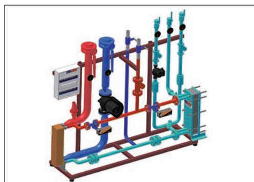
Příklad schématu zapojení a návrh montážní sestavy výměníkové stanice pro obytné budovy
